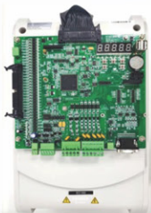
EC160B 采用专用插件板 (通过扁平电缆连接)
